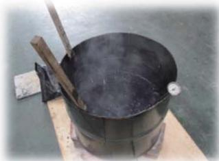
亞力士熱熔瀝青防水膠是由SBS橡膠彈性體、瀝青、合成樹脂及特殊基材聚合而成，100%固成分，具有高彈性、高抗張性、高黏度及耐候性、抗老化等特性，為高效能之防水基材或鋪設材料，材料具有良好的操作性、自癒性，與修補性，非常適合並做為防水膜的搭接或修補，以及伸縮縫工程。
