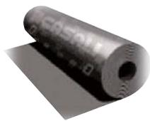
亞力士熱熔式橡化瀝青防水毯系列是由SBS或APP等高品質的熱塑性彈性體作為改性劑改良而成的防水毯，中間夾層有聚酯纖維布或玻璃纖維布作為補強，表面覆以聚乙烯膜、鋁箔膜、砂粒、彩沙、葉岩片所製成的建築防水材料。此產品具有極佳具有抗拉、抗撕裂、抗穿孔、透氣性、防水、耐水壓及耐候性等優異特性，其防水與防潮效果比一般傳統的防水材料更能表現優異。
