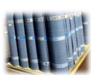
亞力士自黏式橡化瀝青防水毯系列是由 SBS 橡膠彈性體改性成的瀝青防水毯，中間夾層有聚酯纖維布、不織布或銅片作為補強，表面覆以聚乙烯膜(PE)、砂粒、雙面膠膜(附離型紙)或不織布面所製成的建築防水材料。此產品具有極佳具有抗拉、抗撕裂、伸長率、抗穿孔、透氣性、防水、耐水壓及耐候性等優異特性，其防水與防潮效果比一般傳統的防水材料更能表現優異。
