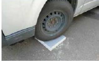
車走行時のコーナリングやタイヤの切り返しによる、ひねりせん断力への耐摩耗性、防水層への影響を確認。
