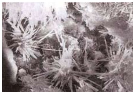
▲ 渗透结晶防水粉处理
