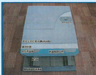
PVC防水系統示意圖
